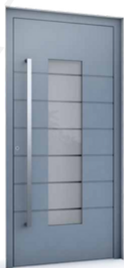
AP31 • Tirant en acier inoxydable AP 46.1625 • Rainures, à l'extérieur • Vitrages : extérieur - VSG 333 intermédiaire - verre sablé avec bandes transparentes intérieur - verre thermo-isolant avec un revêtement à faible émission • Finition de la surface - RAL 7001
