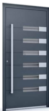
AP18 • Tirant en acier inoxydable AP 80.1625 • Rainures, à l'extérieur • Design effleurant Alunox, à l'extérieur • Vitrages : extérieur - VSG 333 intermédiaire - verre sablé avec bandes transparentes intérieur - verre thermo-isolant avec un revêtement à faible émission • Pliante bas de porte AP 3021 • Finition de la surface - RAL 7015
